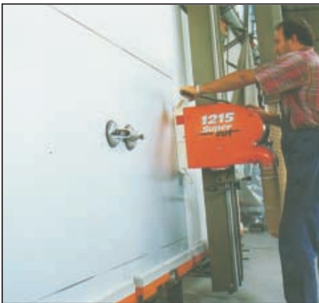
Fig. 25 - La fresatrice Holzer, usata anche per squadrare la lamiera
