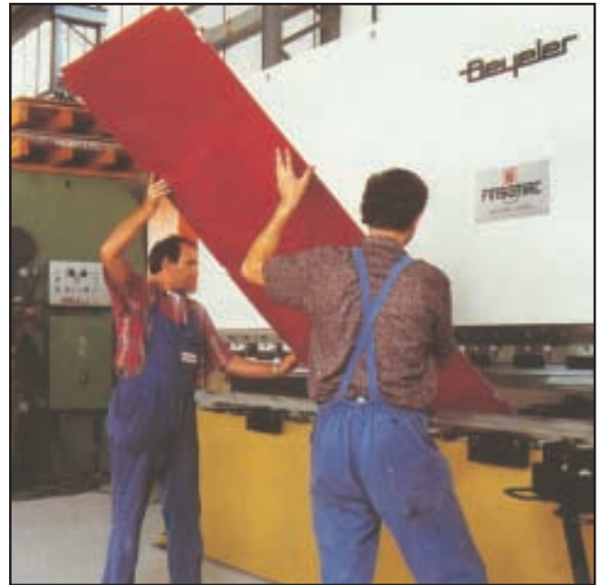
Fig. 29 - Piegatura alla pressa idraulica verticale
