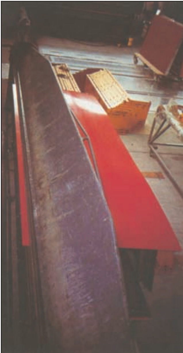
Fig. 28 c) - Una lamiera Mirawall pronta per la piegatura in una macchina dello stesso tipo. La piegatura avviene quando la tavola mobile inferiore ruota verso l'alto (freccie in fig. 28 b) spingendo il bordo a sinistra: movimento analogo a quello della piegatura a mano
